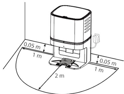
Seiten und 2 m vorne beträgt, so dass sie für den Staubsauger problemlos zugänglich ist.
